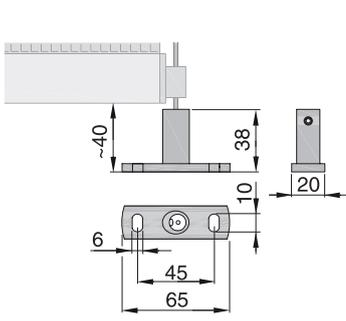
Support de tension du câble pour fixation au sol
